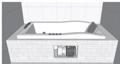
Construção da mureta / fechamento
